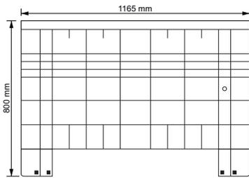
Die EUROPLAST-Box CT/H1 aus hochwertigem HDPE wird im Spritzgussverfahren hergestellt. Sie ist eine normal belastbare Box für die Industrie, für die Lebensmittelproduktion, für Schüttgut und Kleinteile sowie optimal für die Transport- und Lagerhaltung. Die EUROPLAST-Box CT/H1 ist lebensmittelecht und hat glatte Innenwände, die sich leicht reinigen lassen. Sie ist mit 4 Füßen oder 2 Traversen lieferbar.
