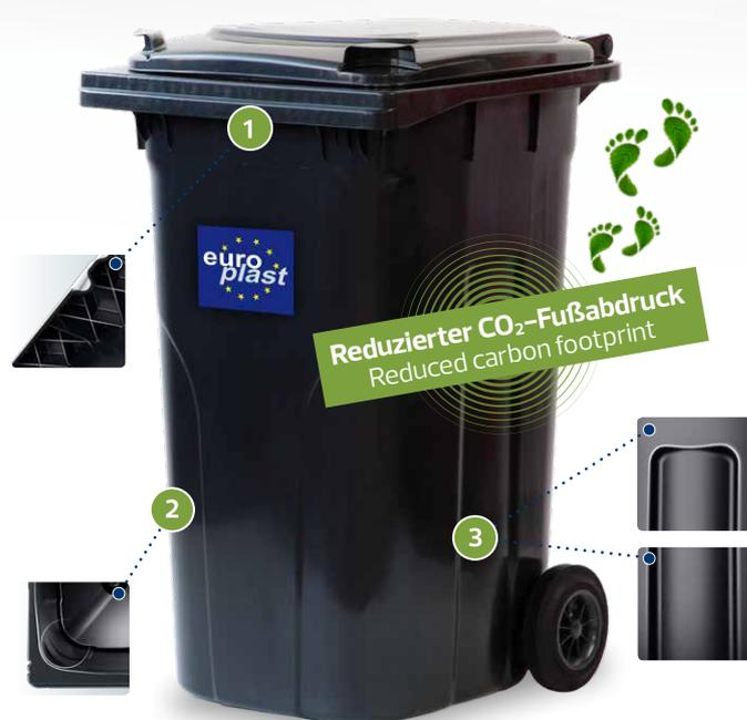
**1)** Innovative X-KAMMLEISTE: Die Diagonalrippen und die Rundumverstärkung erhöhen die Verwindungssteifigkeit des Behälters bei hohem Füllgewicht (Biomüll). **2)** Seitenrundungen: Größere Radien an den Seitenkanten erhöhen die Elastizität des Behälters. **3)** Horizontale und vertikale Sicken für die erhöhte Stabilität bei der Behälteraufnahme.
