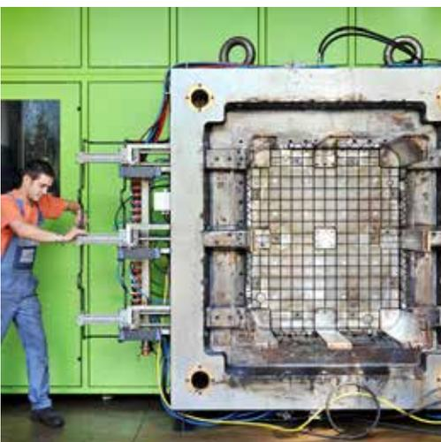
EUROPLAST verfügt über Spritzgussmaschinen, die mit einer Schließkraft von bis zu 4500 Tonnen die Produktion von Kunststoffteilen in überdurchschnittlich großen Dimensionen ermöglichen. Dank der innovativen Fertigungsanlage und der hohen Automatisierungskompetenz des Teams produziert EUROPLAST eine Schlüsselkomponente für Wasserstofftanks.
