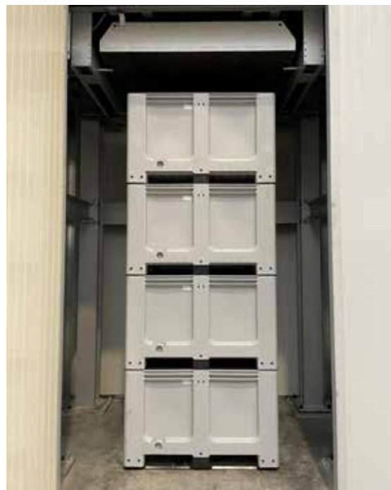
Boxentestanlage mit Belastungs- & Temperatursimulation Box testing facilities & temperature simulation
